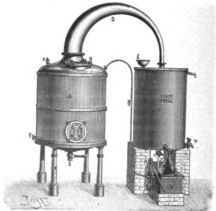
Fig. 12. — Alambic à essence à feu nu, système Egrot.
